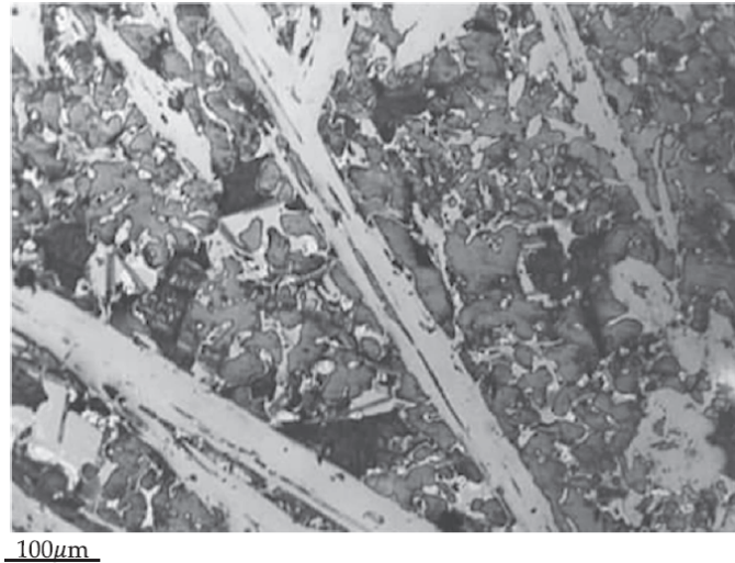
Figure I.10 – Micrographe optique de l'alliage équiolaire multiphasé de 20 éléments MgAlSiMnCrFeCoNiCuZnGeNbMoAgCdSnSbWPbBi [47]
