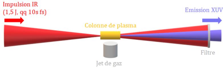
FIGURE 1.19 – Principe du laser XUV collisionnel en régime OFI.
