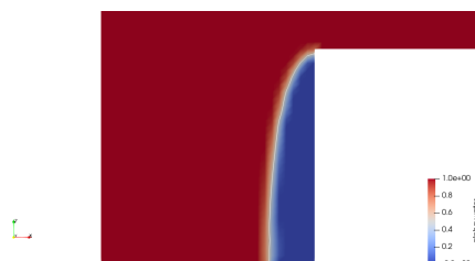
FIGURE 6.18 : Visualisation numérique du phénomène de vena contracta au niveau de la pièce de sortie. La phase liquide est en rouge. La phase gazeuse est en bleu.
