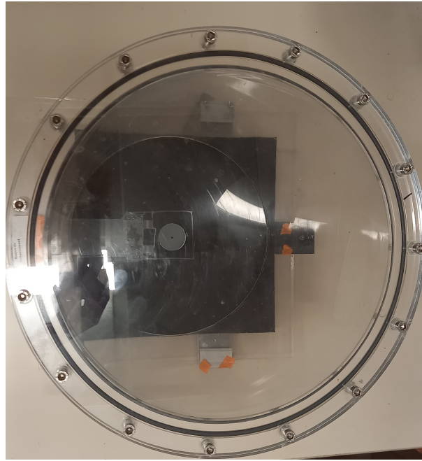
FIGURE 2.5 : Vue de dessus du couvercle de la cuve avec le joint d'étanchéité (en noir) et les 15 vis de serrage.
