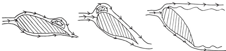
FIGURE 1.8 – Schéma du processus de décrochage de bord d'attaque avec l'augmentation de l'angle d'attaque (de gauche à droite).
