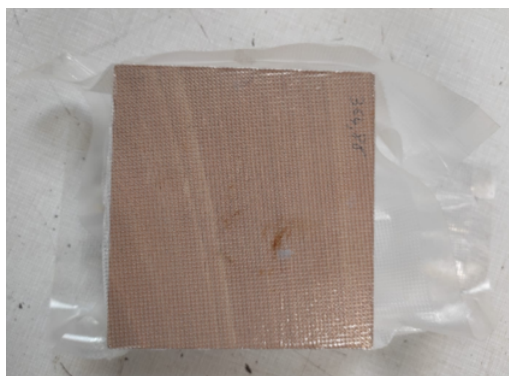
FIGURE 5.2 – Un échantillon de chêne sec stocké dans un sachet sous vide.
