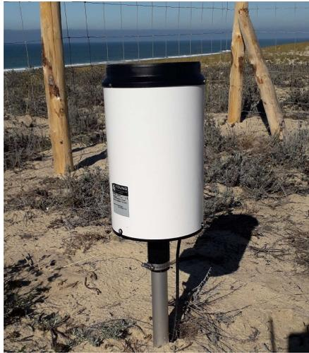
FIGURE 5.5 – Photo du pluviomètre placé au niveau du mât
