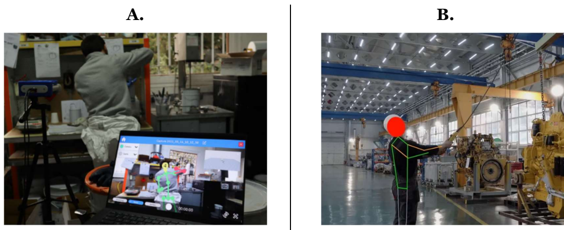
Figure 22. La figure A. représente le système KIMEA Lite de Moovency comportant la caméra et l'avatar du travailleur sur le logiciel ( https://moovency.com/solution-kimea-lite ). La figure B. représente l'application LEA d'Ergosanté qui projette l'avatar sur le salarié ( https://ergosante.fr/application-danalyse-posturale-lea/ ). Les deux solutions proposent un dégradé de couleur (vert orange et rouge) selon le degré d'angulation considéré à risque pour les différentes articulations.
