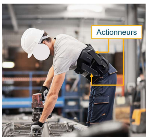
Figure 13. Actionneurs du Japet.W s'adaptant aux mouvements du tronc.
