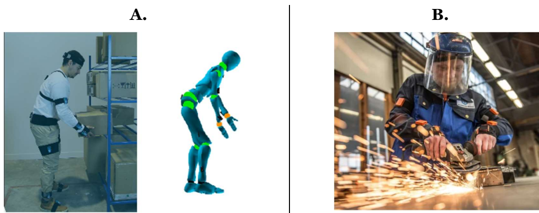
Figure 21. La figure A. représente le système de capteurs proposé par TEA ERGO (T-Sens Motion) ainsi que l'avatar visible en direct. Les articulations se colorent en vert lorsque l'angulation est dans une zone à faible risque de TMS puis tend vers le rouge lorsque l'angulation est considérée dangereuse pour l'articulation ( https://www.teaergo.com/fr/ ). La figure B. représente le système corps entier de Xsens (MVN awinda) utilisé au poste de travail dans une situation d'analyse ergonomique ( https://www.movella.com/products/motion-capture/xsens-mvn-awinda ).
