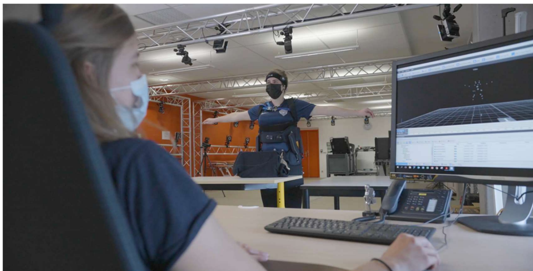
Figure 20. Photo de la plateforme de capture de mouvement de l'Université de Technologie de Compiègne. Le logiciel sur ordinateur permet de visualiser les marqueurs anatomiques positionnés sur le sujet.
