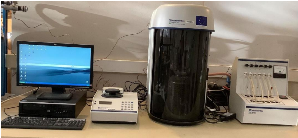
Figure 45 : Essai d'adsorption-désorption d'azote via la machine Gemini VII 2390
