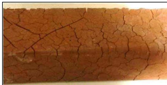
Figure 41 : Fissuration de surface de géopolymère à base de métakaolin en condition de cure sous atmosphère sèche (20 °C et HR = 50 %) (Pouhet 2015)
