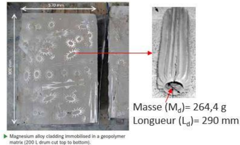
Figure 161 : Les quantités de déchet MgZr inclus dans le géopolymère (Muzeau et al. 2018)
