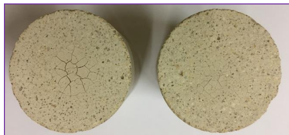
Figure 50 : La fissuration en peau de MGEO-avec-NaF après le séchage à 105 °C
