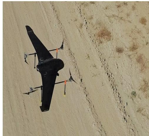
(d) Hybrid-wings: Skywalker X8 tilt-rotor
