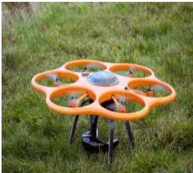
(d) Mining UAV: Aibotix Aibot X6
