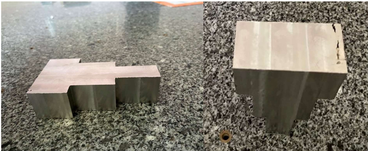
Figure 3. 13 Pièce d'étude après usinage.
