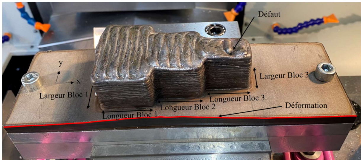
Figure 3. 5 Pièce d'étude après la fabrication additive.
