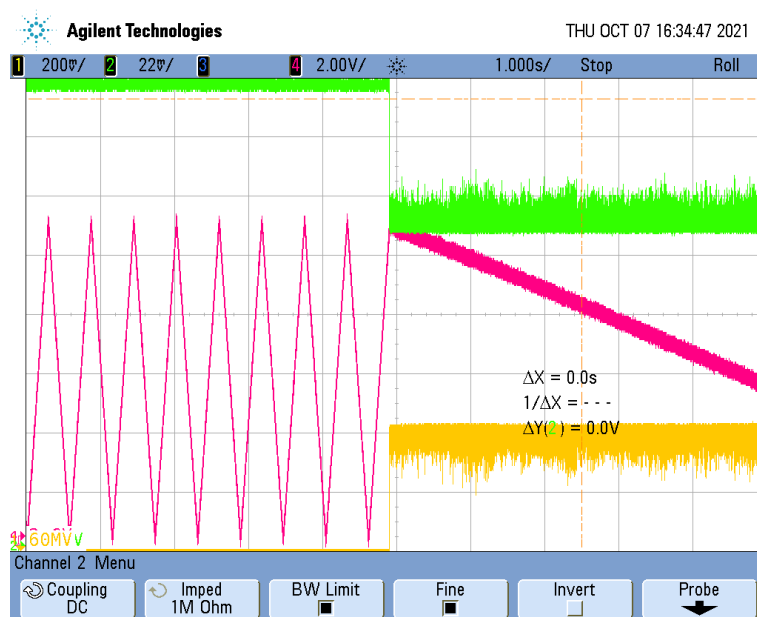
FIGURE 3.12 – Signaux d’asservissement du laser NKT sur la cavité. La courbe jaune représente l’intensité reçue en transmission de la cavité, la courbe verte représente l’intensité reçue en réflexion de la cavité et la courbe rose la tension de commande du composant piezo-électrique situé dans le NKT. La partie gauche de la figure montre les signaux en boucle ouverte tandis que la partie droite de la figure montre les signaux en boucle fermée.
