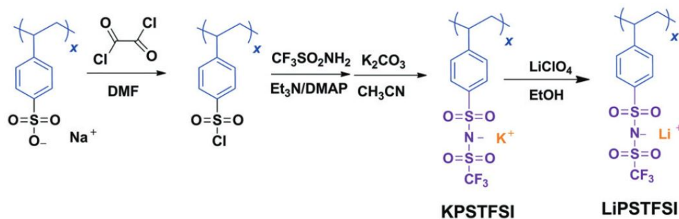
Figure 1.23 – Voie de synthèse d'électrolytes LiPSTFSI obtenus par réaction par fonctionnalisation du poly(styrène sulfonate) de sodium (NaPSS)[105, 106].
