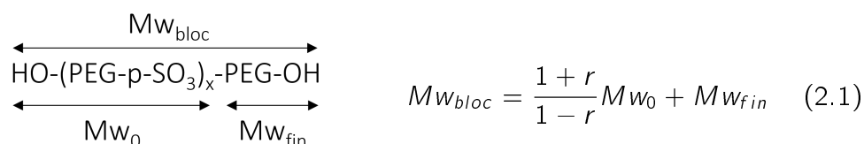
Figure 2.3 – Présentation de l'équation de Carothers, avec r le ratio en p-SO 3
