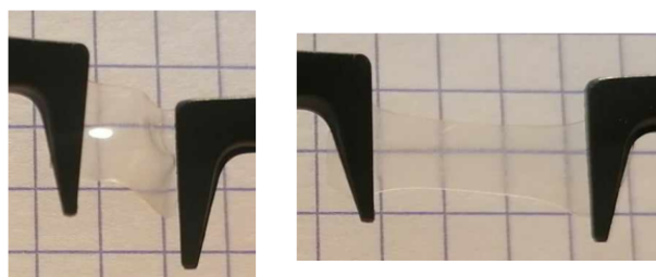
Figure 2.24 – Exemple d'une membrane réticulée (110 \mu\text{m} d'épaisseur)
