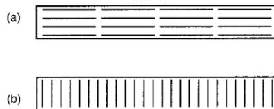
FIGURE 1.12 – Schéma des deux lames avec des dépôts de films par bande. (a) Configuration parallèle. (b) Configuration perpendiculaire. Extrait de [31].
