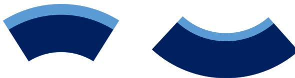
FIGURE 1.7 – Film en compression (à gauche) et en traction (à droite).
