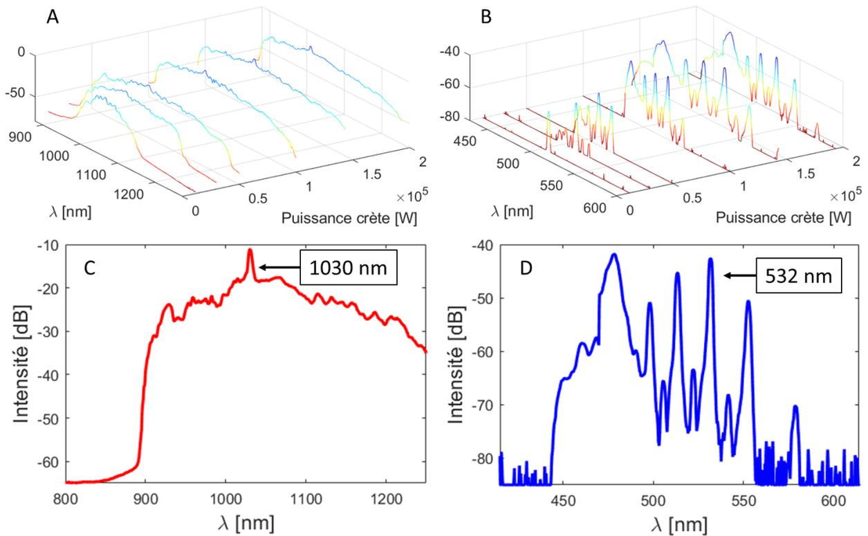
Figure 47 : A. Evolution spectrale mesurée en sortie de la fibre Alcatel 50/125 mesurée entre 900 et 1300 nm autour de la pompe. B. Puis entre 450 et 600 nm autour de la SH. C. Exemple d'un enregistrement spectral entre 900 et 1300 nm à 200 kW. D. Exemple d'un spectre entre 450 et 600 nm pour une puissance crête de la FF de 200 kW.
