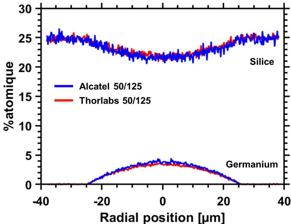
Figure 31 : Compositions atomiques (%) en Silice et Germanium dans le diamètre des deux fibres enregistrées par EDX. La superposition de la mesure EDX des deux fibres MMGRIN de 50 μm de diamètre de cœur montre qu'il n'y a pas de différence de dopage entre les deux fibres.
