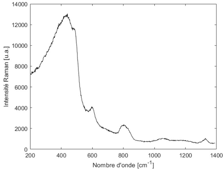
Figure 49 : Allure des spectres Raman d'une silice dopée au germanium. Sur ces spectres, comme présenté au Chapitre 1, on retrouve les pics caractéristiques de la silice : avec le massif large à  $440\text{ cm}^{-1}$ , le pic D1 à  $489\text{ cm}^{-1}$ , le pic D2 à  $606\text{ cm}^{-1}$ , le pic à  $800\text{ cm}^{-1}$  des liaisons Si-O-Si.
