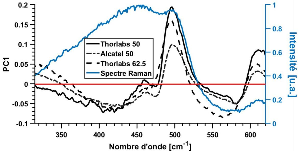
Figure 59 : Composante principale des différentes fibres corrélée à la distribution de la température fictive. En bleu, le spectre Raman de la silice dans le centre de la fibre Alcatel est rappelé.
