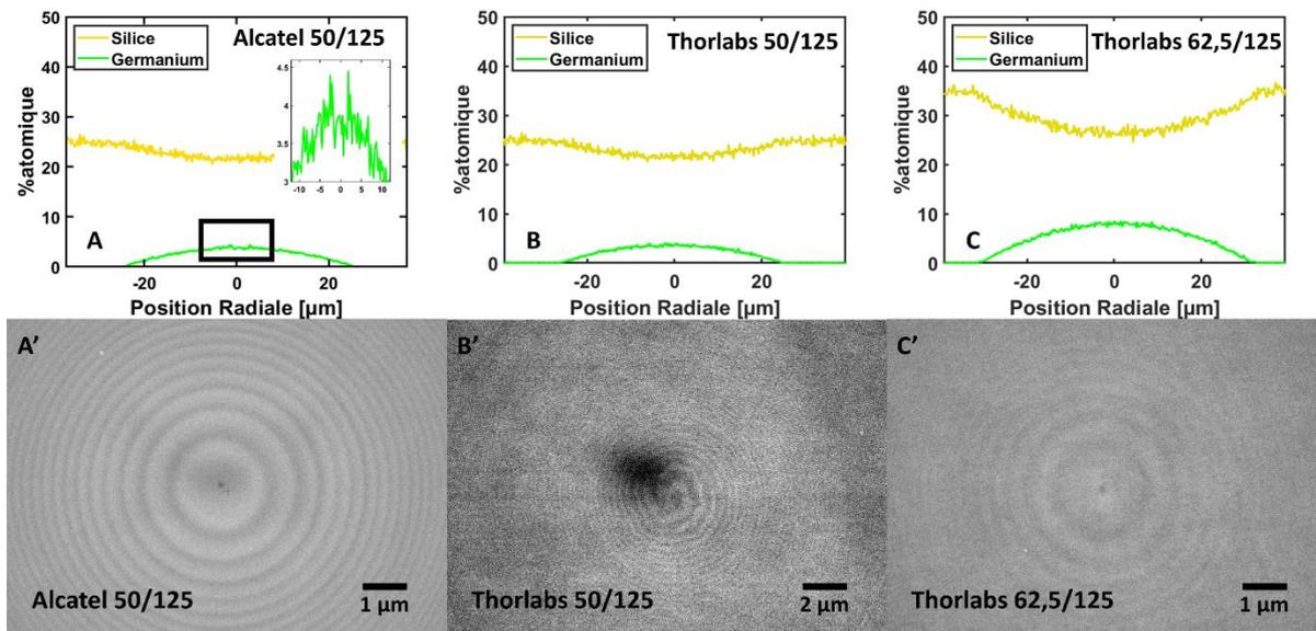
Figure 30 : (Haut) Analyses de la composition chimique (données EDX). L'insert en A permet de bien mettre en évidence les deux surintensités sur le signal du Ge, qui sont à rapprocher de l'anneau central mis en évidence lors de la mesure de l'indice de réfraction par IFA. (Bas) Images MEB (obtention à partir des électrons rétrodiffusés, tension de travail – 15 kV) du cœur des fibres optiques MMGRIN.
