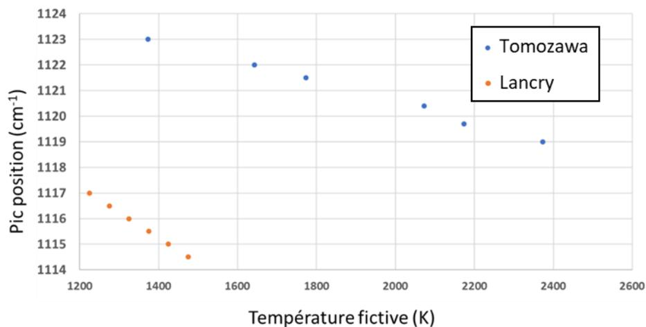
Figure 11 : Résultat des équations empiriques de Tomozawa (bleu) et Lancry (orange) permettant de relier la température fictive et la position spectrale du maximum de réflectivité IR.
