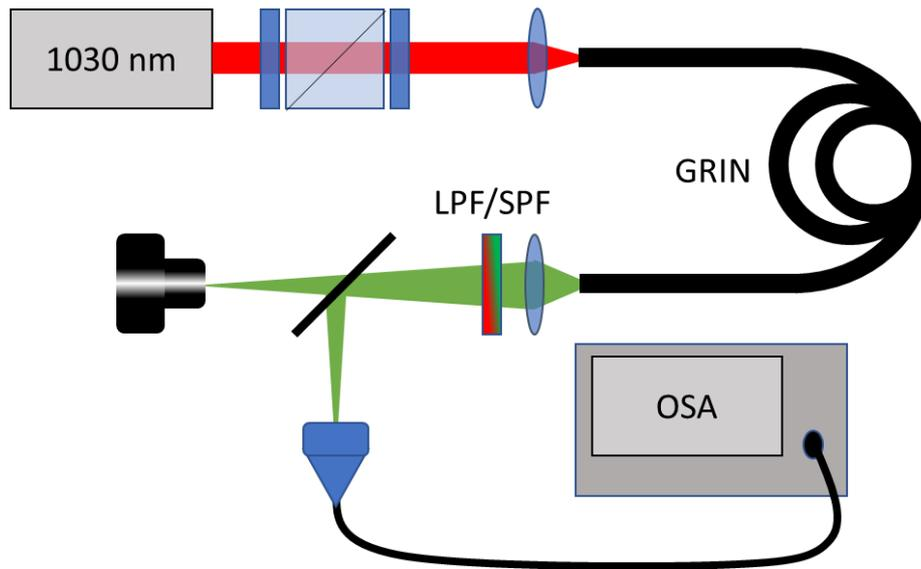
Figure 46 : Expérience d'élargissement spectral dans une fibre Alcatel MMGRIN 50/125 préalablement polée à 1064/532 nm. Utilisation d'un laser 1030 nm, 300 kHz, 10 ps. Un jeu de filtres et une caméra CCD 2D permettent de visionner le mode de différentes fréquences. L'analyse spectrale est réalisée par le spectromètre ANDO OSA.
