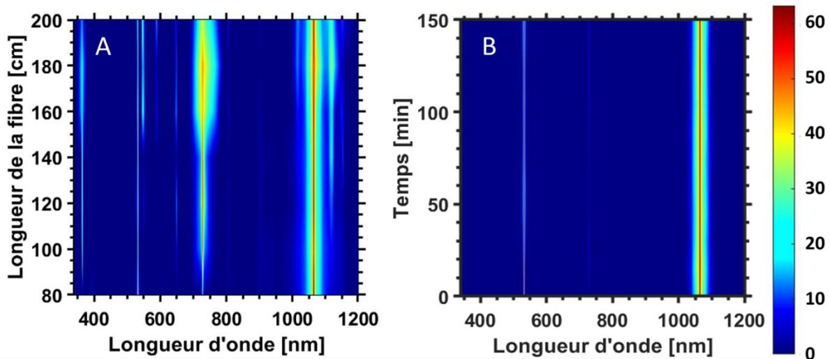
Figure 43 : A. Cut back de la fibre Alcatel. B. Evolution spectro-temporelle du poling optique dans 80 cm de fibre Alcatel 50/125.
