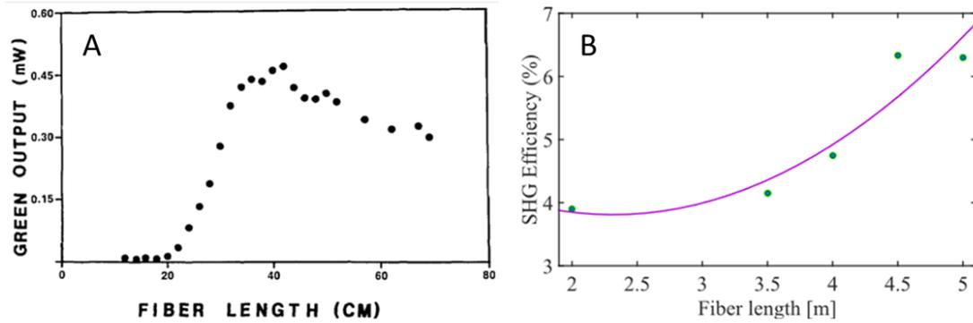
Figure 44 : A. Puissance moyenne de la SH selon la longueur d'une fibre monomode avec un cœur dopé phosphore de 8  $\mu\text{m}$  réalisé par Osterberg et Margulis en 1986. B. Efficacité de conversion de puissance pour différentes longueurs de fibre multimode parabolique. Selon les auteurs, l'efficacité tend à augmenter avec la longueur de la fibre [Eftekhari 2017]
