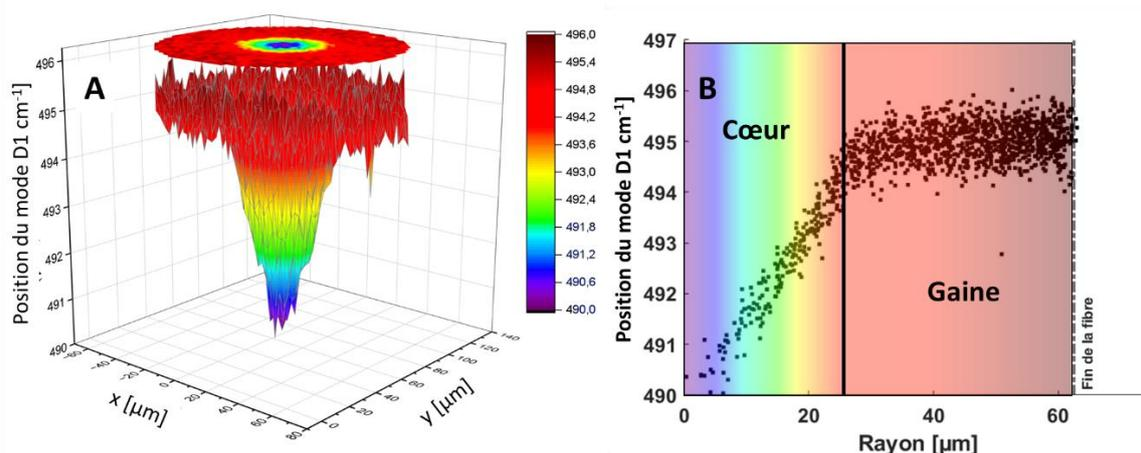
Figure 53 : Etude de la position du pic D1 dans la fibre Alcatel 50/125 :
