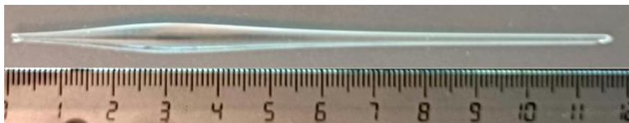
Figure 5 : Goutte générée lors d'un tirage de fibre MMGRIN en silice dopé germanium.
