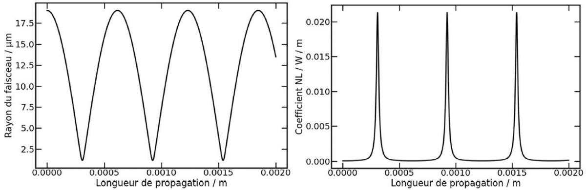
Figure : 21 Parametres utilisés pour le calcul de  $\gamma_{NL}$  pour la résolution de la GNLSE 1+1D selon le modèle développé par Conforti et al. ; Gauche : Evolution du rayon modal au cours de la propagation ; Droite : évolution de  $\gamma_{NL}$  au cours de la propagation.
