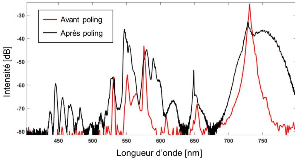
Figure 40 : Comparaison du spectre visible d'une fibre Alcatel de 5 m de long avant et après poling.
