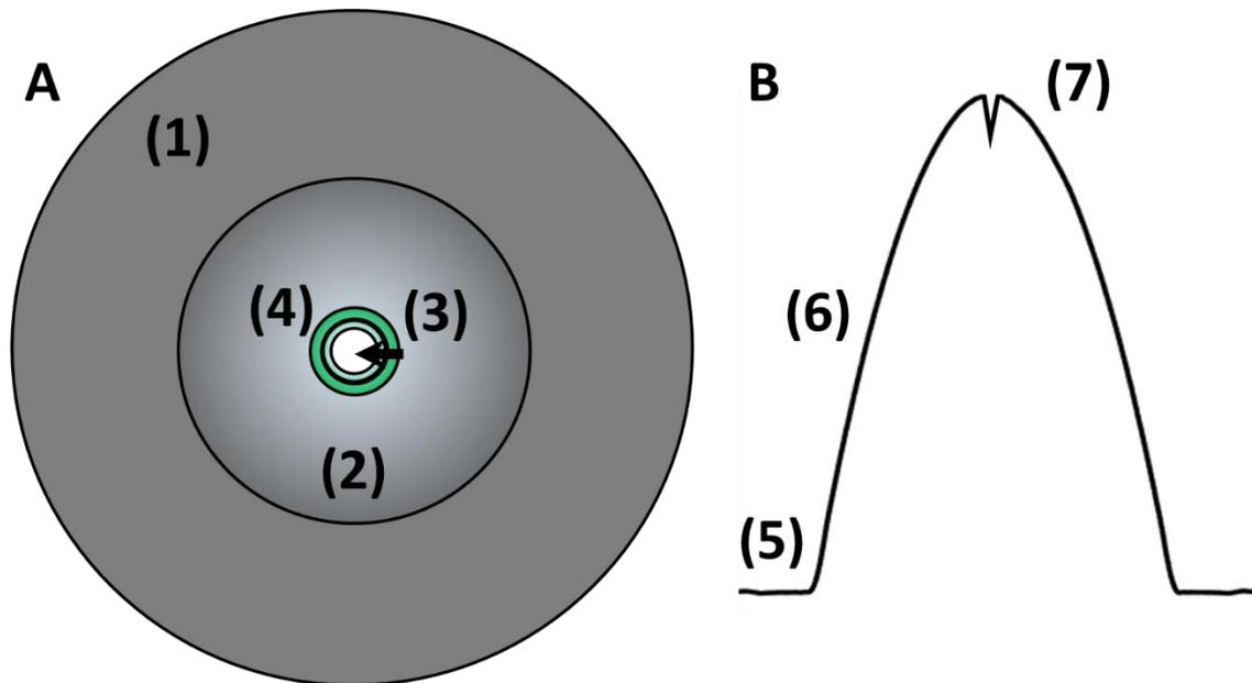
Figure 2 : **A.** Schéma de principe d'un rétreint d'une préforme de MMGRIN créée par MCVD. (1) Tube de silice, (2) Cœur à gradient d'indice, (3) Remplissage du cœur par superposition de couches par méthodes internes, (4) Couches de silice dopées déposées, **B.** Schéma du profil d'indice d'une MMGRIN (5) Indice de la gaine, (6) GRIN, (7) Représentation du résultat de l'évaporation de l'oxyde de Germanium en MCVD.
