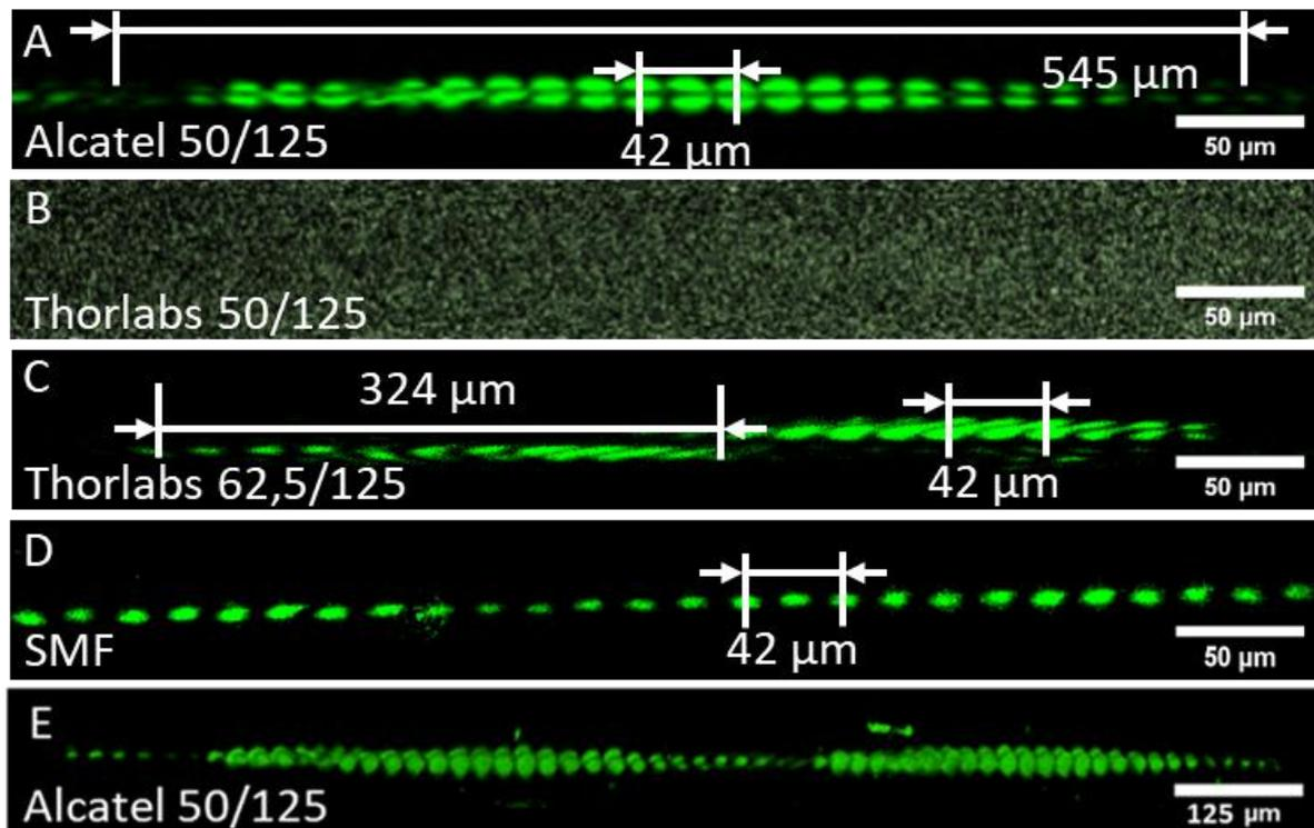
Figure 36 : Images acquises en microscopie bi-photonique : inscription de la susceptibilité non linéaire d'ordre 2 dans quatre fibres différentes. A : Fibre Alcatel 50/125  $\mu\text{m}$  ; B : Fibre Thorlabs 50/125  $\mu\text{m}$  (pas d'inscription). C : Fibre Thorlabs 62,5/125  $\mu\text{m}$  ; D : Fibre monomode dopée Germanium, E : Reconstruction 3D des zones  $\chi^{(2)}$  inscrites lors du poling optique.
