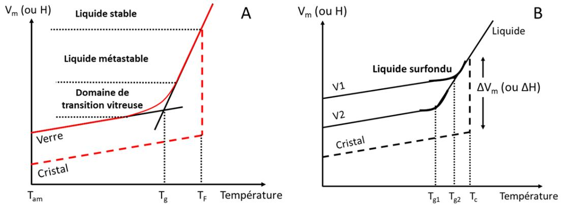
Figure 6 : A. Evolution du volume molaire ( $V_m$ ) ou encore de l'enthalpie molaire en fonction de la température. B. impact de la vitesse de refroidissement sur la variation du volume molaire  $V_m$  d'un verre avec  $V_1$  et  $V_2$  indiquant les volumes molaires respectifs des verres obtenus pour les différentes vitesses de refroidissement dont  $V_1 > V_2$ .
