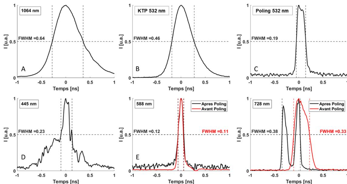
Figure 42 : Mesure à mi-hauteur de la durée d'impulsions avec une photodiode de 40 GHz. A. Durée d'impulsion de la FF, B. Durée d'impulsion de la SH en sortie du KTP, C. Durée d'impulsion de la SH après poling optique, D. Durée d'impulsion de la longueur d'onde apparaissant après poling à 445 nm, E. Durée d'impulsion de la longueur d'onde à 588 nm, F. Durée d'impulsion du pic principal des GPI.
