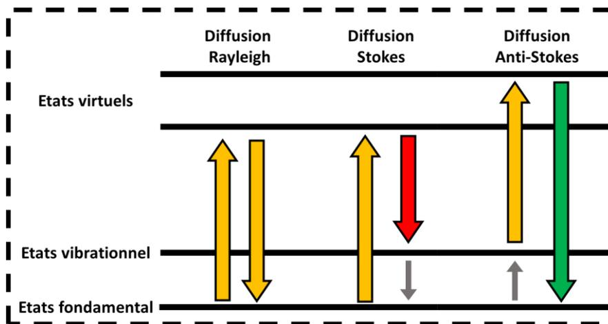
Figure 20 : Diagramme énergétique illustrant les processus de diffusion Raman.
