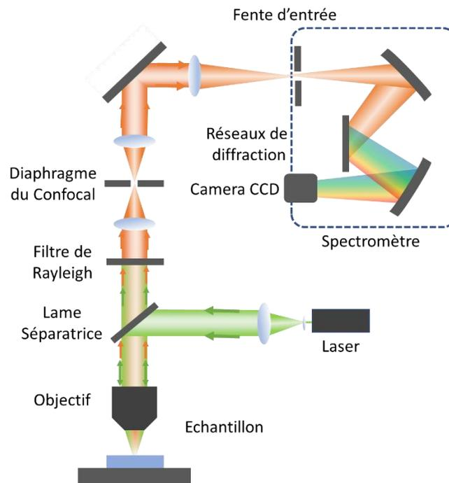
Figure 12 : Schéma de principe d'un microscope confocale Raman récupérant le signal émis par un échantillon excité par un laser.
