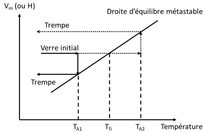
Figure 8 : Variation vers des valeurs inférieures ou supérieures de la température fictive initiale  $T_{fi}$  respectivement : températures fictives atteintes  $T_{A1}$  et  $T_{A2}$ .
