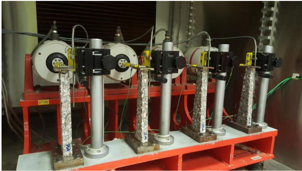
Figure 4.11 Dispositif expérimental 3MC conçu pour les essais de module complexe 2PB-TR menés sur enrobés au laboratoire de l'UGE à Bouguenais (44) (SIROMA, 2022, p. 106).
