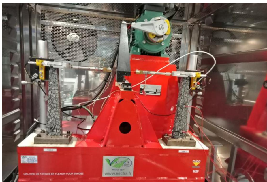
Figure 4.12 Machine de fatigue à deux voies pour les essais 2PB-TR sur enrobés au laboratoire d'Eiffage à Ciry-Salsogne (02) (BENABOUD, 2022, p. 45).
