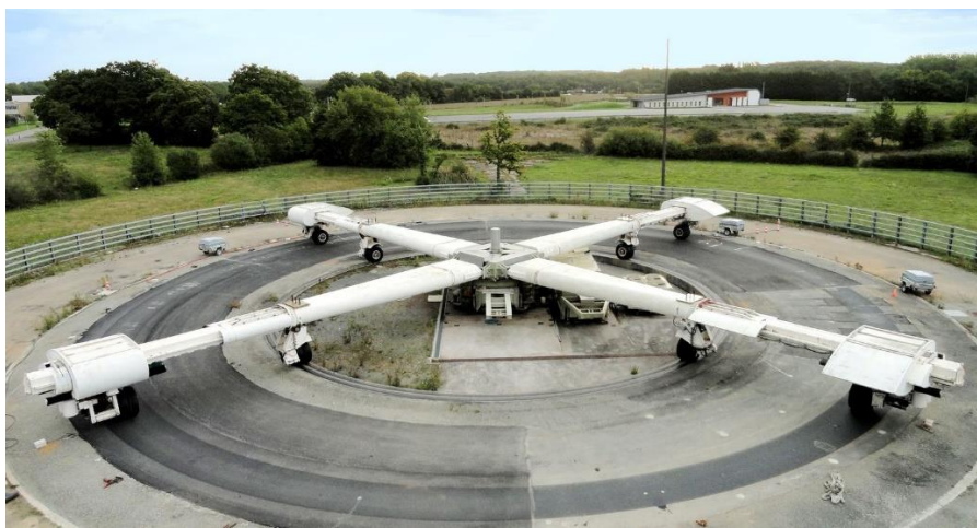
Figure 4.3 Manège de fatigue de l'Université Gustave Eiffel à proximité de Nantes (© LAMES, UGE, n.d.).
