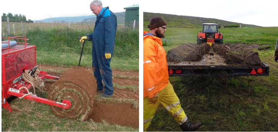
Figure 128: extraction mécanique de strengur (cliché : SC, 2012) et transport de bloc klömbra par tracteur (cliché SC : 2017).
