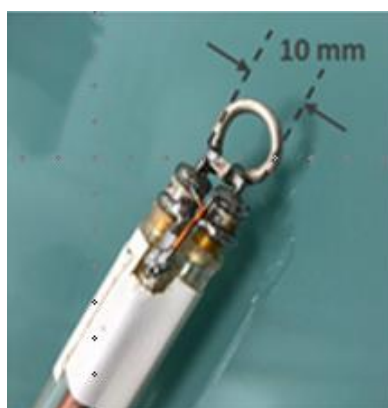
Figure 39 Antenne RF surfacique de 10 mm de diamètre faite au laboratoire.
