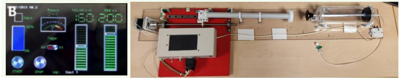
Figure 32 Photo du système d'administration de dioxygène gazeux enrichi en ^{17}\text{O} .
