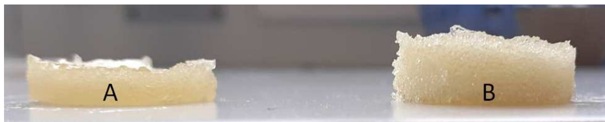
Figure 1. Mousses NIPU obtenues par évaporation d'eau à 100°C pendant 30 min en fonction de la quantité d'agent gonflant : A) 0,015 g d'H 2 O (1,4% wt) et B) 0,06 g d'H 2 O (5,4% wt).
