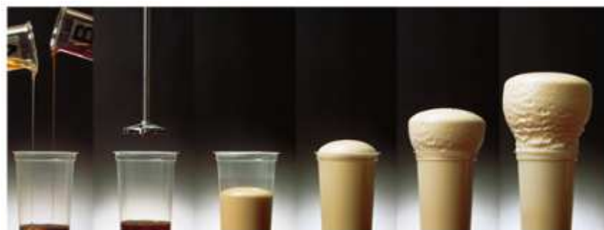
Figure 2 : Expansion d'une mousse polyuréthane. [4]
