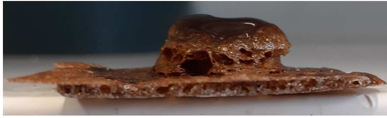
Figure 23. Mousse obtenue par RICFP à partir de la formulation EX512/UVR6110 (9 :1) 3,5% wt I-Sb et 5% wt TPED.
