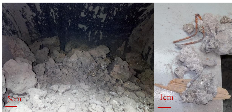
Figure 23 : Cendres de sous foyer brutes (à gauche), pollution métallique des cendres (à droite).
