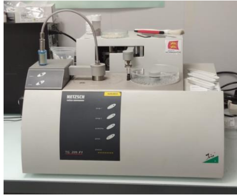
Figure 15 : Appareil permettant l'analyse thermogravimétrique
