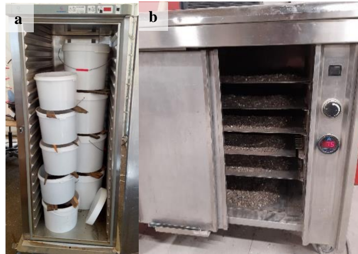
Figure 35 : Protocole temporaire de séchage : (a) séchage des FT par empilement de seaux ouverts, (b) dispositif de séchage retenu.
