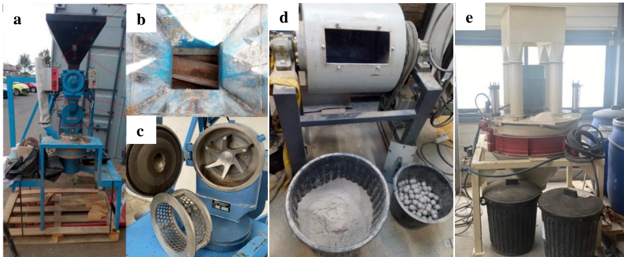
Figure 37 : Type de broyeurs, broyeur à marteaux fixes (a), distributeur (b) et chambre de broyage (c), broyeur à boulets (d), broyeur à marteaux mobiles (e).
