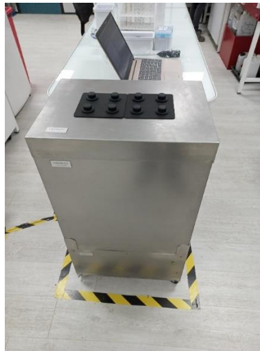
Figure 14 : Calorimètre isotherme, I-Cal Ultra Isothermal Calorimeter
