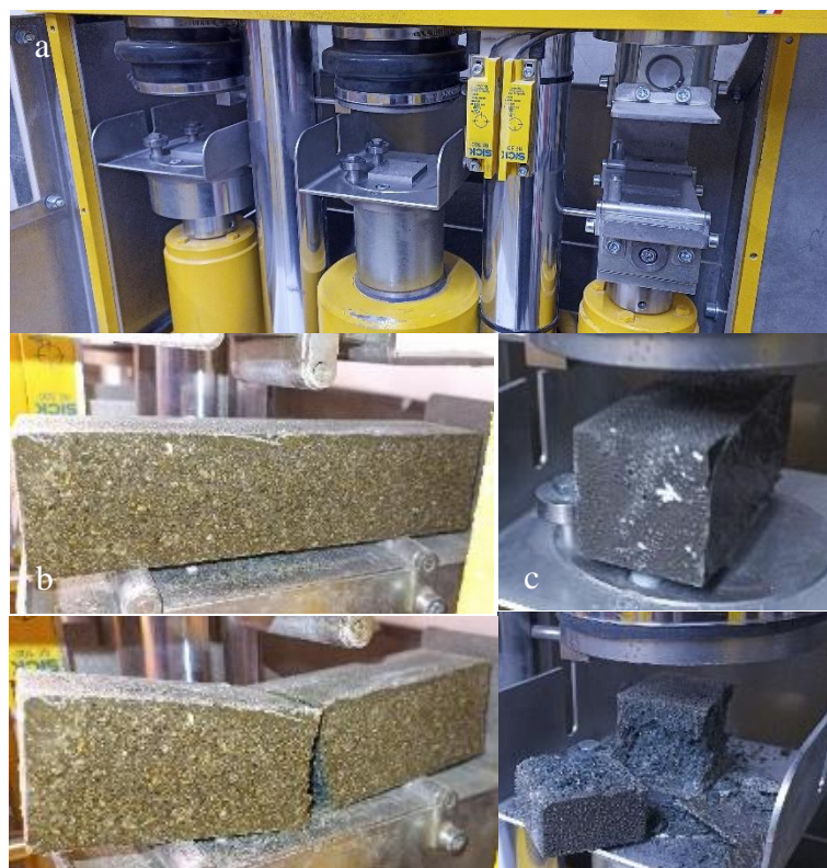
Figure 18 : Essais mécaniques : a) banc d'essai de résistance mécanique, b) dispositif de flexion en 3 points, c) dispositif de compression.
