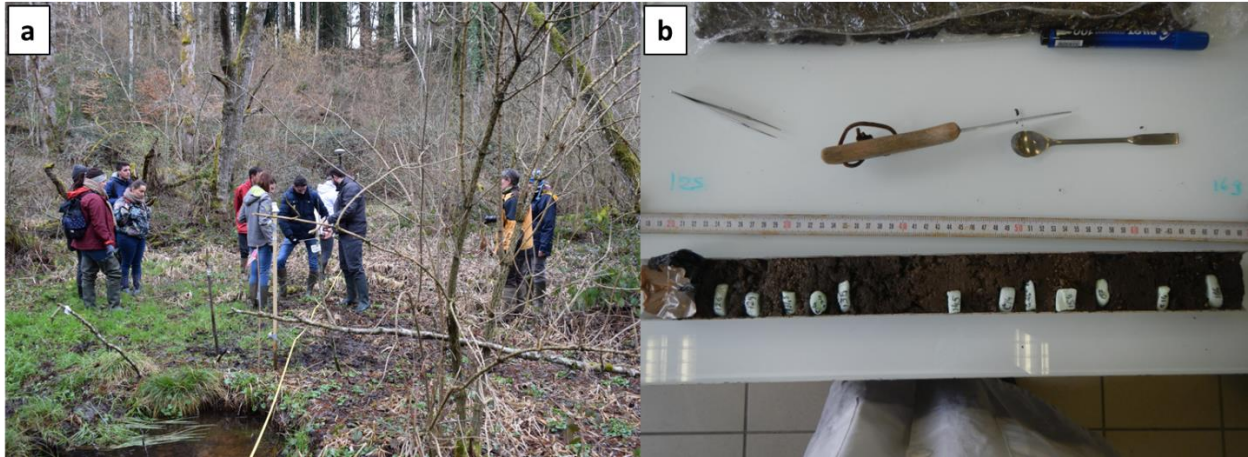
Figure II-5: (a) Carottage de la zone humide de Rophin, le 4 mars 2020. (b) Prélèvement des couches sédimentaires de la carotte T2-P1bis pour les analyses morphologiques des diatomées et la datation au carbone 14 ( ^{14}\text{C} ).
