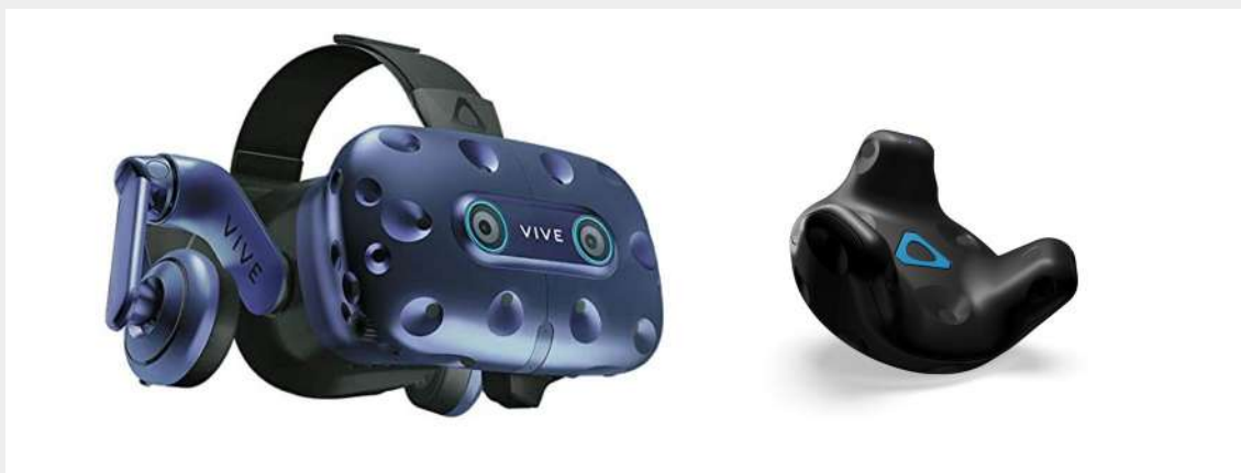
Fig. 63 · Le casque Vive Pro Eye et les capteurs de position/orientation
