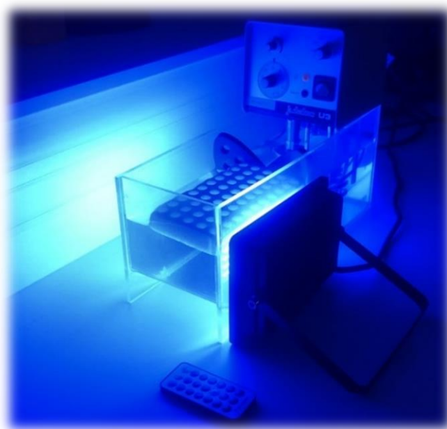
Figure 28. Photoincubateur utilisé pour la détermination de CMI (ici en lumière bleue).
