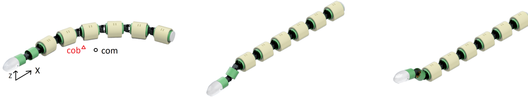
FIGURE A.4 – Les trois modes propres de la dynamique interne pour le corps droit où toutes les articulations du corps sont mises à zéro. Le mode instable est à gauche et les deux autres sont stables. Nous avons représenté schématiquement la position du centre de flottabilité (triangle rouge, cob) et de masse (carré noir, com). Ils sont en fait plus proches avec une distance relative de 2mm pour une longueur de robot de 1m.
