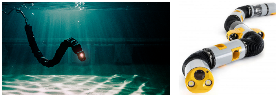
FIGURE 1.8 – Gauche : Le robot Mamba extrait de [48]. Droite : le robot Eelume avec des propulseurs extrait de [8].
