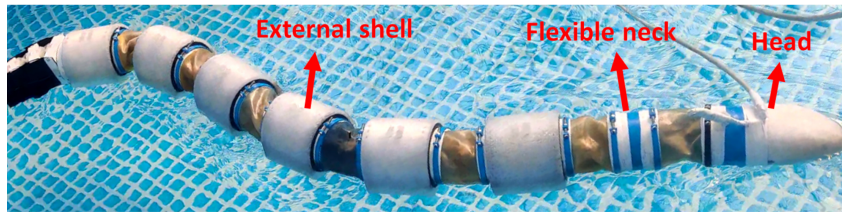
(a) Le prototype de robot serpentiforme Natrix
