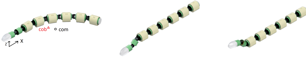
FIGURE A.4 – Les trois modes propres de la dynamique interne pour le corps droit où toutes les articulations du corps sont mises à zéro. Le mode instable est à gauche et les deux autres sont stables. Nous avons représenté schématiquement la position du centre de flottabilité (triangle rouge, cob) et de masse (carré noir, com). Ils sont en fait plus proches avec une distance relative de 2mm pour une longueur de robot de 1m.
