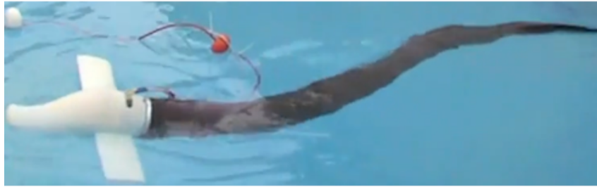
FIGURE 1.5 – Le robot RAAMO évoluant à la surface de l'eau avec son ombilical bien visible.
