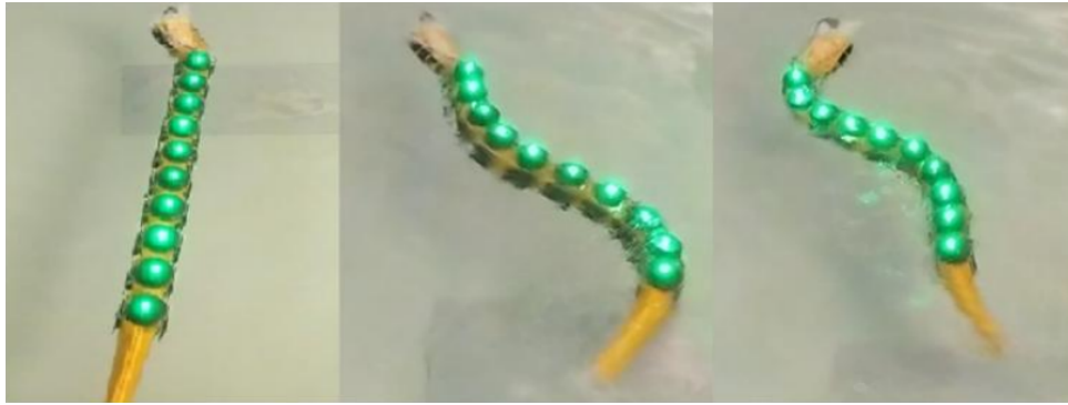
FIGURE 1 – Illustration du roulis du robot Agnathax (EPFL/Biorob) lors de sa nage à la surface libre malgré la présence de flotteurs (entourant les LEDs vertes).
