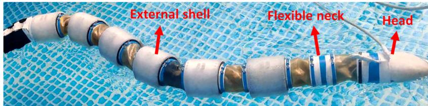
(a) Le prototype de robot serpentiforme Natrix
