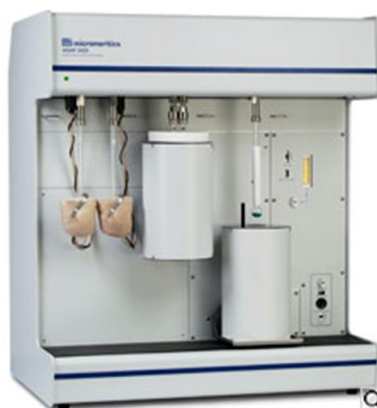
Figure II. 19 : photographie de l'analyseur adsorption/désorption du gaz (BET)
