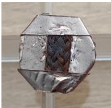
Figure II. 18 : photographie d'un échantillon de catalyseur (avant utilisation) avec un dépôt de couche d'or (4 nm d'épaisseur) permettant de faire l'analyse avec le MEB
