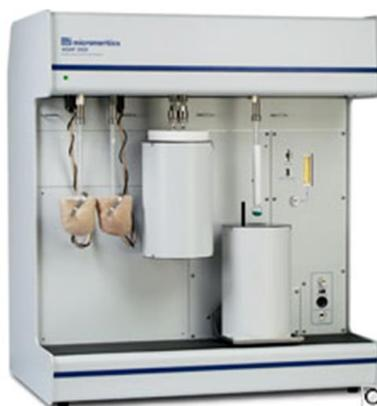
Figure II. 19 : photographie de l'analyseur adsorption/désorption du gaz (BET)
