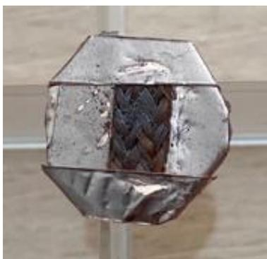
*Figure II. 18 : photographie d'un échantillon de catalyseur (avant utilisation) avec un dépôt de couche d'or (4 nm d'épaisseur) permettant de faire l'analyse avec le MEB*
