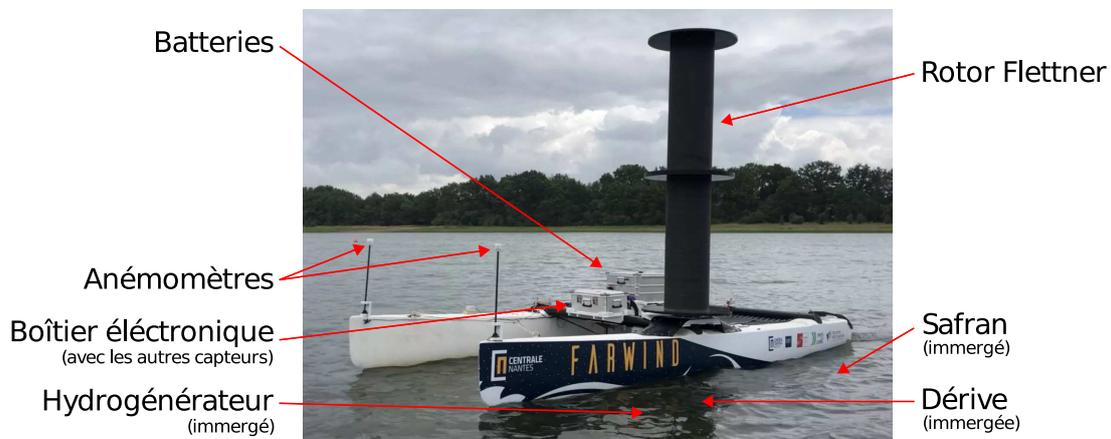
Fig. 28 – Prototype Farwind
