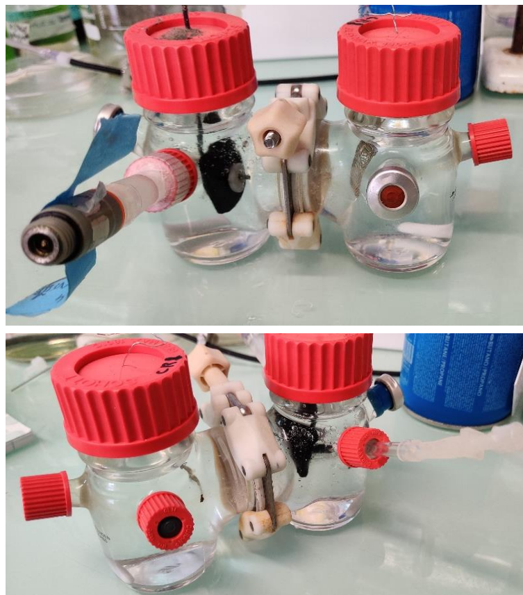
Figure 2-5 : Petits réacteurs utilisés pour la culture de souche pure avec l'électrode de référence au premier plan. A) La chambre cathodique est à gauche de la photo (électrode en feutre de carbone + référence au premier plan) et la chambre anodique à droite. L'électrode de référence est maintenue en place à l'aide d'un bouchon GL18. B) Le côté opposé des réacteurs où l'on retrouve la canule d'apport de gaz qui est en verre et bouchée par un septum comme pour les grands réacteurs. Ces canules permettent l'apport de gaz au centre de la chambre cathodique. Les prélèvements sont fait au travers du septum bleu présent tout à droite de la photo. Les sorties des réacteurs non utilisées sont fermées par des bouchons GL14.
