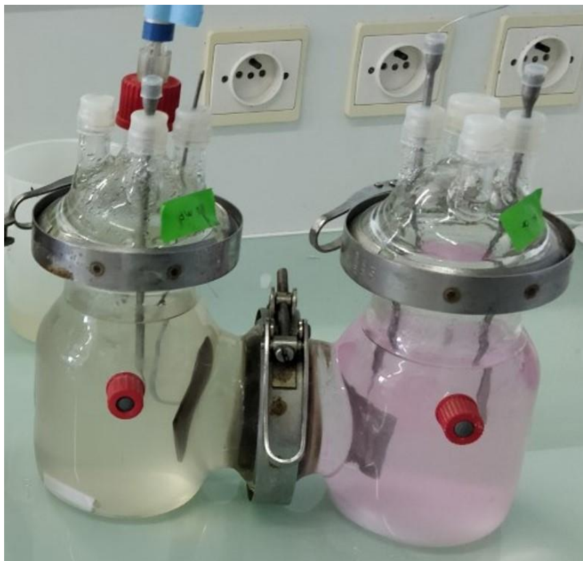
Figure 2-2: Réacteur utilisé pour la culture de G. sulfurreducens à l'anode. La chambre anodique est à gauche et la chambre cathodique à droite. Les tiges des électrodes et les canules sont passées au travers de bouchons à rabats étanches. L'étanchéité autour de l'électrode de référence est réalisée grâce à un bouchon GL25 et joint associé.
