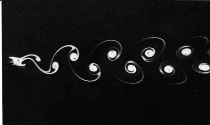
FIGURE II.12 – Régime laminaire bidimensionnel pour Re = 105 [Hyke, 1988].
