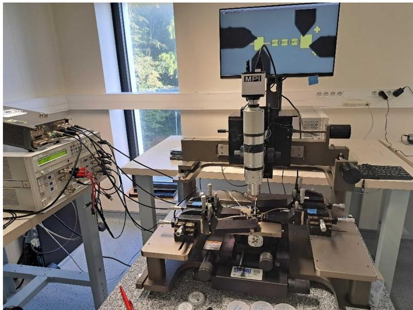
Figure 3.8 : Banc de mesure I-V en configuration 4 pointes.
