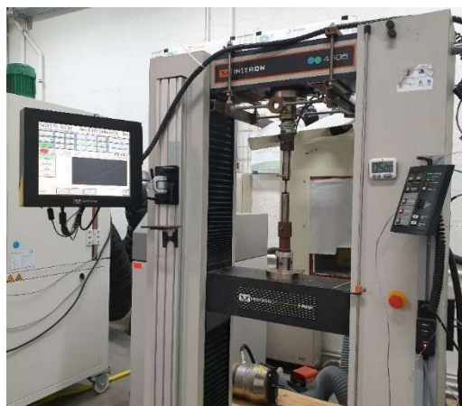
Figure 2-14 : Montage d'un essai de traction sur une éprouvette plate.
