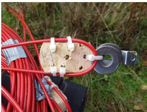
Figure III. 8. Photographie montrant l'un des câbles de fibre optique utilisé à Port-Douvot.
