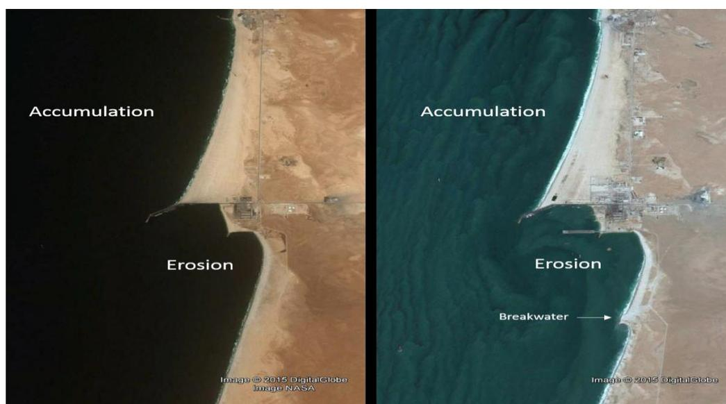
*Photo 1. 26: Type d'érosion côtière favorisée par l'installation d'infrastructures mal adaptées : Exemple du port de Nouakchott avec ensablement au nord de la digue, et érosion marine au sud de l'épi.*
