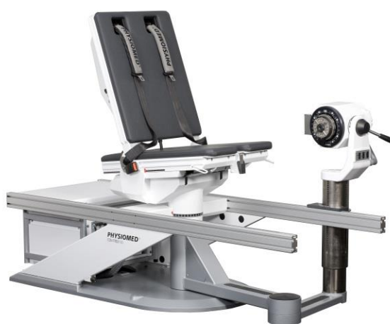
Figure 40. Dispositif isocinétique Con-Trex utilisé afin d'évaluer la force maximale volontaire en conditions isométrique, concentrique (60 et 180^\circ/\text{s} ) et excentrique ( -60^\circ/\text{s} ).
