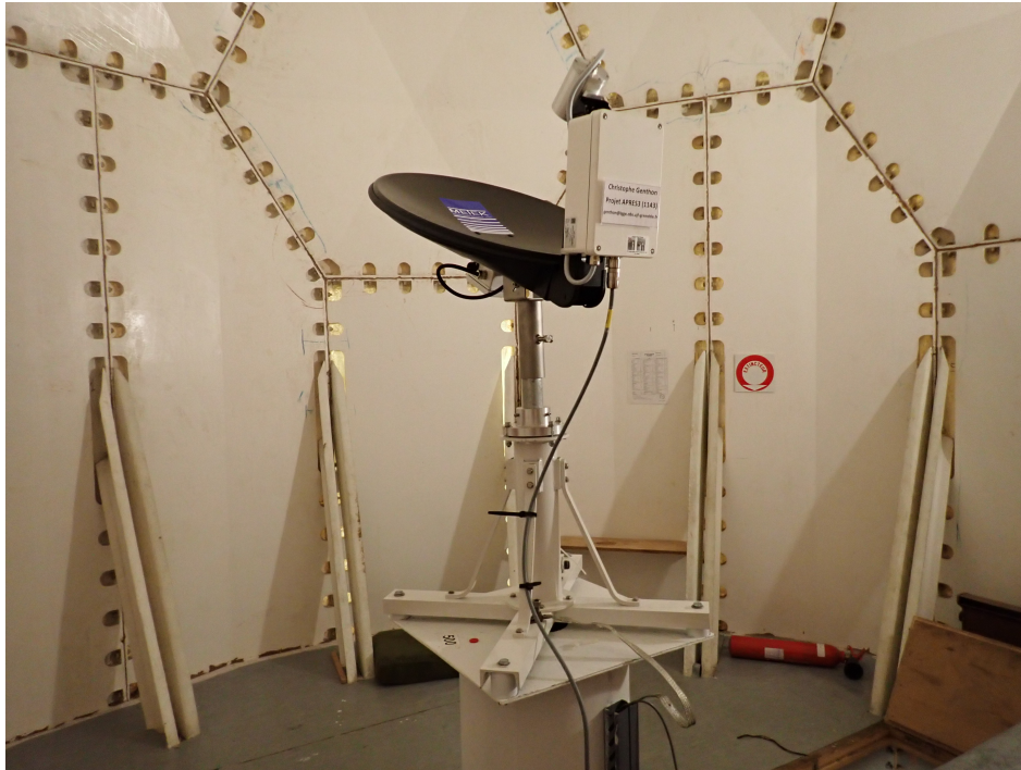
FIGURE 19 – Photographie du MRR installé dans son radôme à la station DDU , été austral 2022. Source : Valentin Wiener, Laboratoire de Météorologie Dynamique ( LMD )
