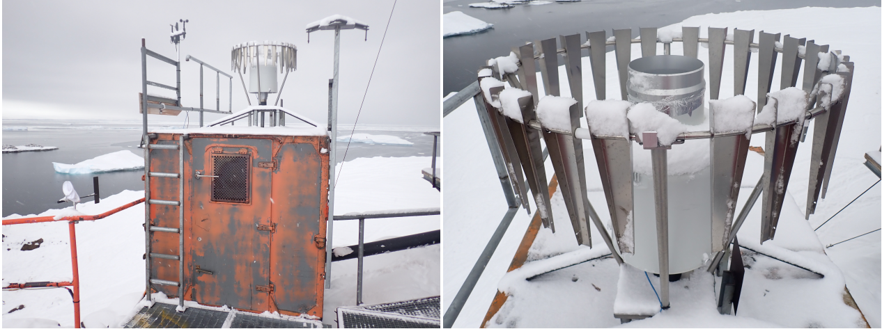
FIGURE 20 – Photographies du pluviomètre installé sur le toit d'un abri à la station DDU , lors de l'été austral 2022. Source : Valentin Wiener, LMD
