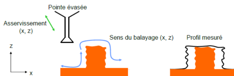
FIGURE 1.13 – Schématisation d’une reconstruction de profil avec un CD-AFM [41].
