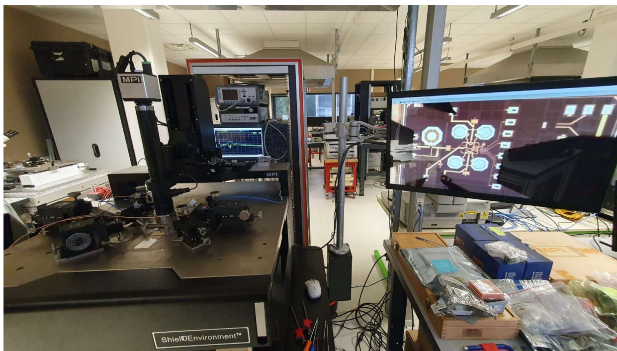
Figure III.37 Conception A ( balun + filtre) en mesure
