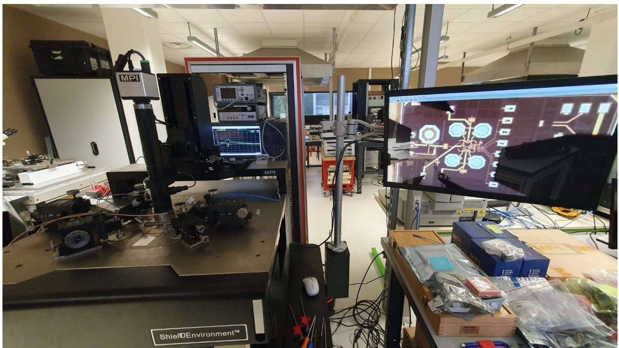
Figure III.37 Conception A ( balun + filtre) en mesure
