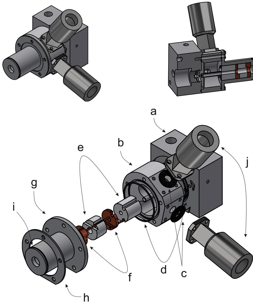
FIGURE 4.3 – Plan de l'injecteur à décharge (inspiré du design de l'équipe de McCarthy [157]) dans son état de développement actuel : vue assemblée (en haut à gauche), vue coupée (haut à droite) et vue éclatée. Corps de l'injecteur (a), pièce intermédiaire (b), joints (c), joints toriques (d), séparateurs en téflon (e), électrodes en cuivre (f), tête de l'injecteur en téflon (g), pièce en inox (h), joint torique (i), connecteurs girafes (j). Crédit : G. Dekyndt
