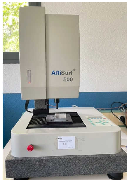
Figure A-6. Photographie du profilomètre (Altisurf 500) du laboratoire.
