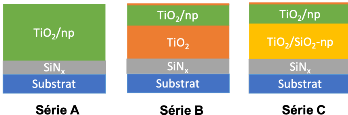
Figure 5-6. Architectures des 3 séries de films nanocomposites préparés avec incorporation de différents types de nanoparticules dans une matrice de TiO_2 avec trois configurations différentes d'incorporation des nanoparticules : introduction continue (A), introduction partielle (B), introduction partielle avec sous-couche rugueuse (C).
