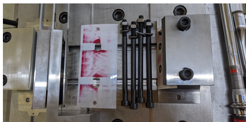
(a) Film de mesure de pression au pied d'une aube.
