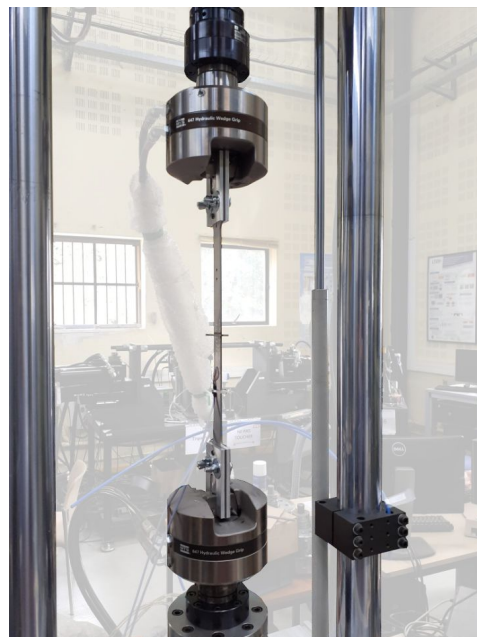
FIGURE II.24 – Aube insérée entre les mors de la machine de torsion.
