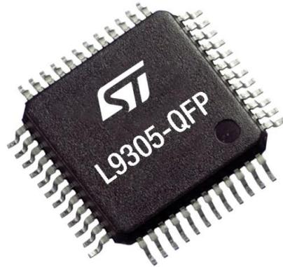
*Figure I.4 : Exemple d'un boîtier QFP avec 48 pattes de connexions en gull-wing (TQFP48 de ST Microelectronics)*
