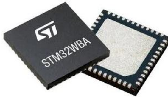
Figure I.5 : Exemple de boîtiers QFN avec 48 broches de connexions (UFQFPN48 de ST Microelectronics)
