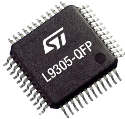
Figure I.4 : Exemple d'un boitier QFP avec 48 pattes de connexions en gull-wing (TQFP48 de ST Microelectronics)
