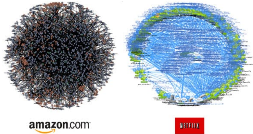
Figure A.1: Visualisation sous forme de Graphe des Microservices des applications de Amazon et Netflix en 2016 par [Cockcroft 2016a, Cockcroft 2016b].
