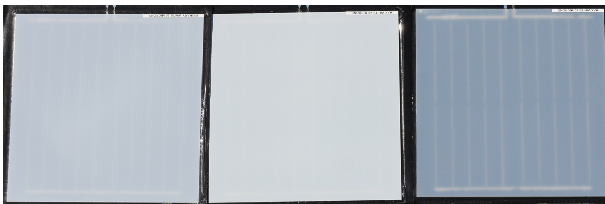
FIGURE 4.7 – Modules blancs avec différentes épaisseurs d'encre. De gauche à droite : 3.5 µm (50%), 7 µm (100%) et 1.75 µm (25%)
