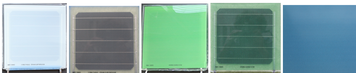
FIGURE 2.20 – Cinq des 8 modules fabriqués pour le vieillissement. De gauche à droite : Papyrus White, Papyrus White Dotted, Grass Green, Grass Green Dotted, Pigeon Blue
