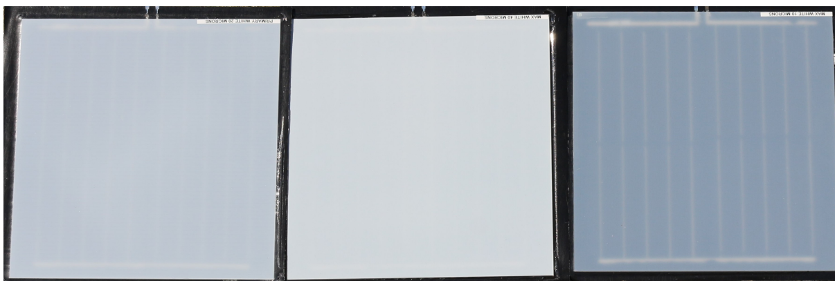
FIGURE 4.7 – Modules blancs avec différentes épaisseurs d'encre. De gauche à droite : 3.5 \mu\text{m} (50%), 7 \mu\text{m} (100%) et 1.75 \mu\text{m} (25%)
