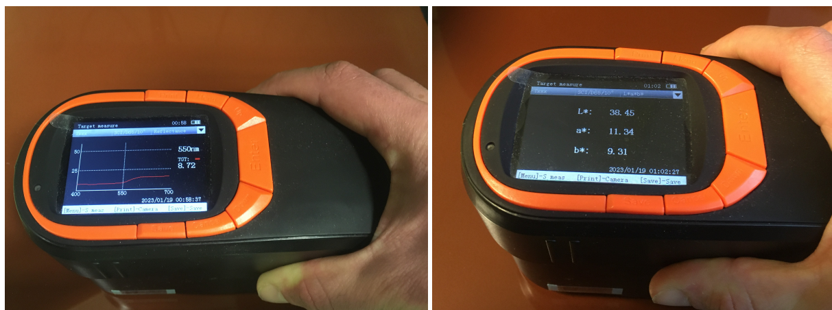
FIGURE 2.10 – Observation de la réflectance d’un module terracotta avec le colorimètre et détermination des coordonnées L^*a^*b^* correspondants
